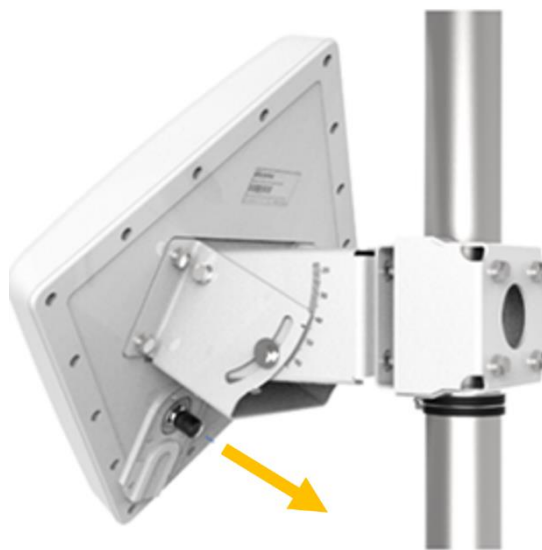
図 20 ダストキャップの取外し
