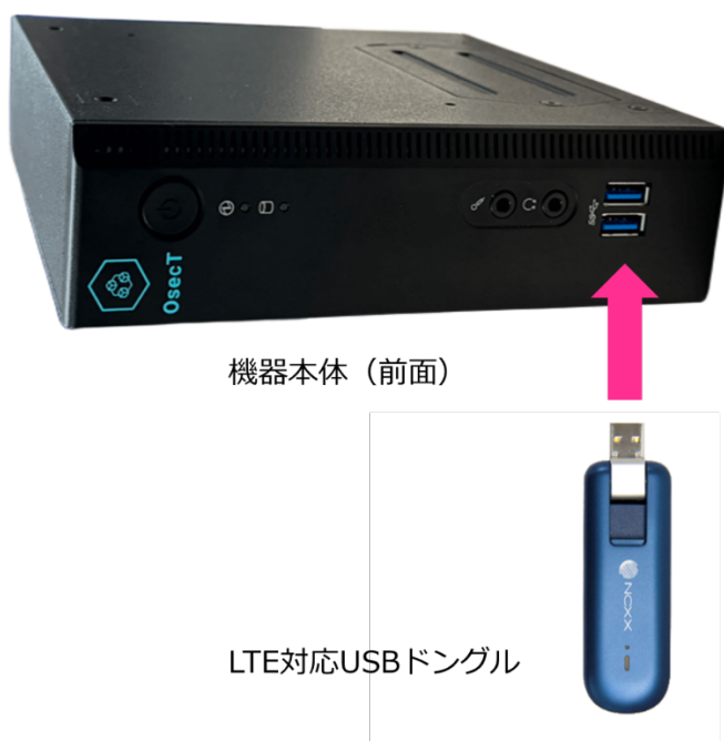
図. LTE 対応 USB ドングルの接続
