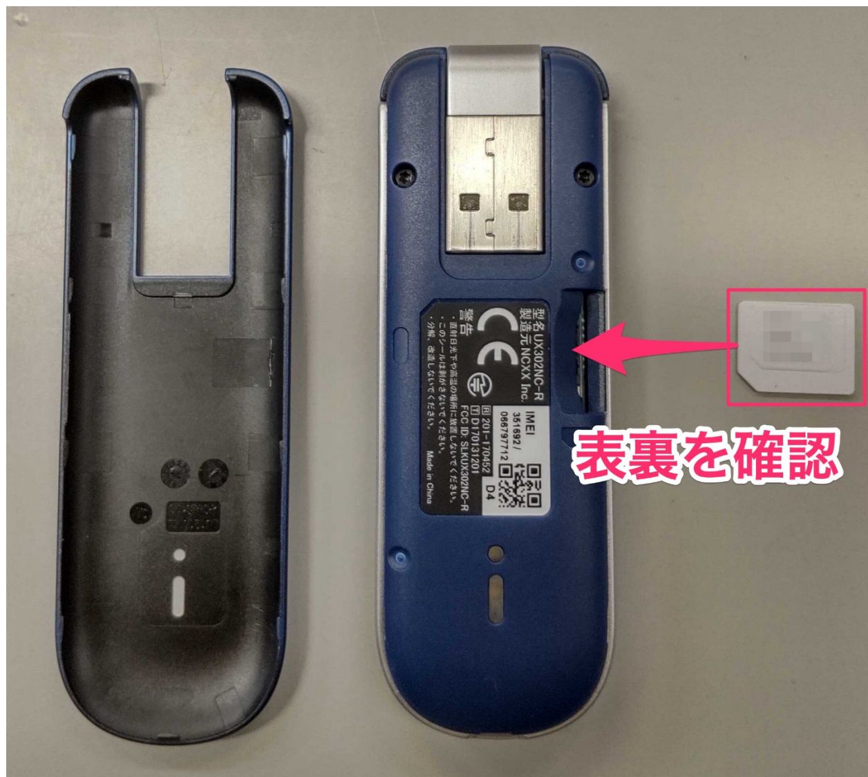
図. SIM カードの挿入方法
